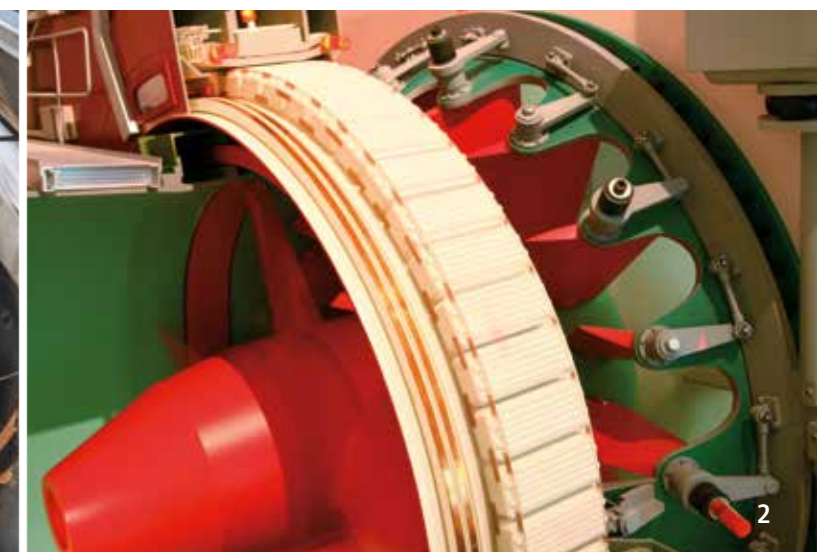
1 | Einbau der ersten Rohrturbine im Wasserkraftwerk Rheinfelden 2 | Straflo-Maschinengruppe im Modell
